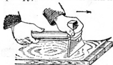
Рис. 136. Фанерование в притирку при помощи притирочного молотка
