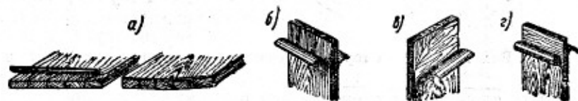
Рис. 128. Оклейка щита фанерой
